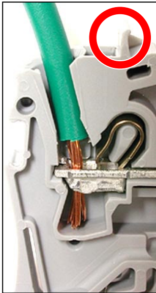
正しいむき長さで結線された例
