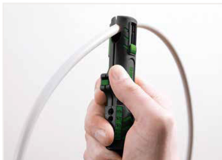
ケーブルの被覆剥き例：縦カット
