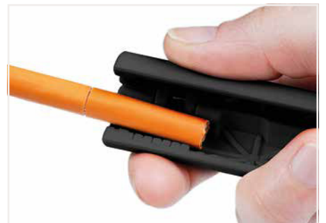
ケーブルの被覆剥き例
