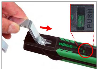
交換するフックブレードを差し込みます。カチッと音がして「PUSH」表示の穴に緑色のロックが見えていることを確認してください。
