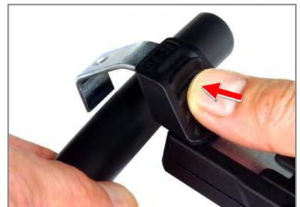
内部ブレード刃出し量調整ダイヤルを回し、電線被覆の厚みに合わせて刃出し量を調整します。(刃出し量：0～3mm)
