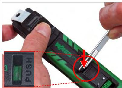
「PUSH」表示の穴に交換するフックブレードまたはマイナスドライバを挿し、ロックを解除します。
