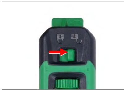
反対側のフックブレードのロック/解除スイッチを解除位置にします。
