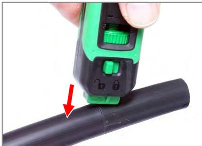
フックブレードのロックを解除しストリッパをケーブル被覆に押し付けます。
