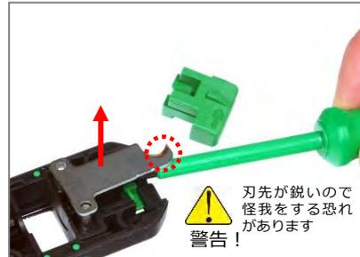
ドライバなどを使用してフックブレードを取り外します。
