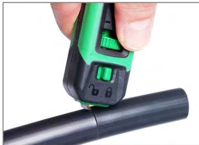
フックブレードの刃先をケーブル被覆の切れ目に刺します。
