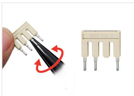
ジャンパの不要な極をねじって折り取り、飛越ジャンパに加工することができます その場合の定格電圧は 500 V です 2000・2001・2002・2004 シリーズで可能です
