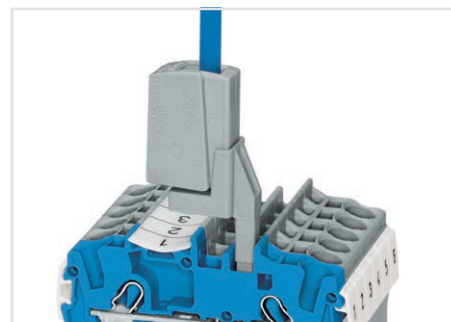
テストタップ (型番: 2009-182) は 2.5 mm² までのテスト用電線を工具なしで結線できます
